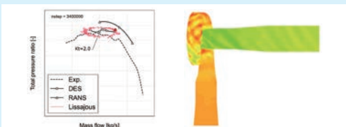
流量と全圧比のリサージ変動 (左図) と配管も含めた圧力変動分布 (右図)
