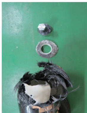
図1 タイプ4CFRP製容器の口金破損
