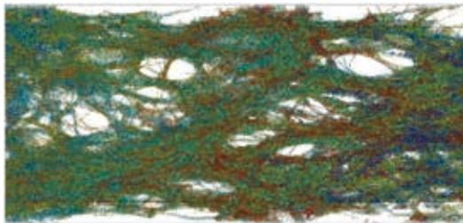
ポリカーボネート引張破壊の粗視化分子動力学解析
