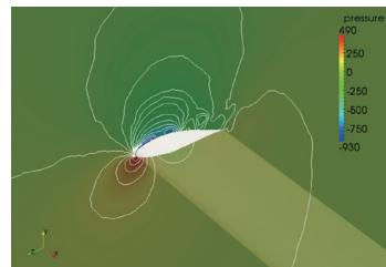
Fig.4 多段の翼列振動シミュレーション：翼周り流れの圧力分布
