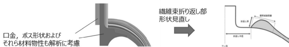
軸対称モデル ボス部近傍の繊維束折り返し部の改良
