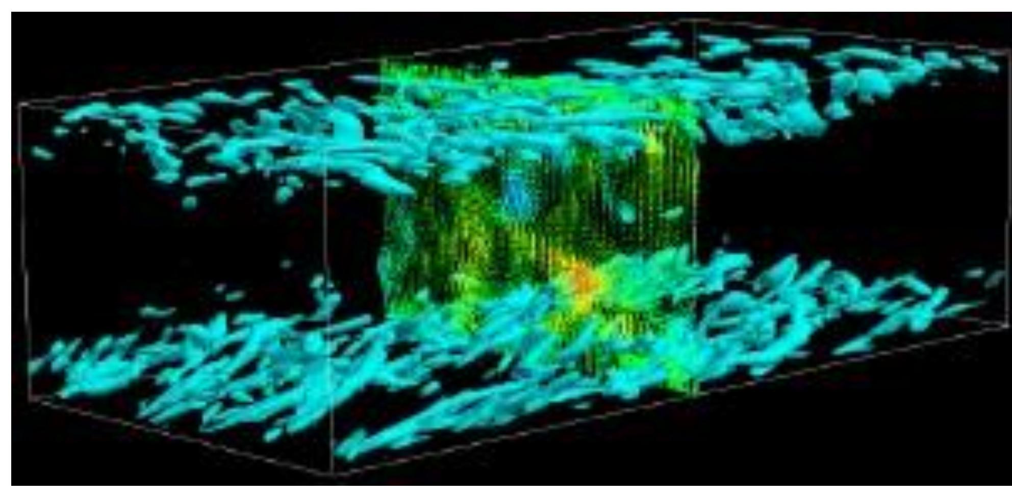
チャネル乱流の渦の等価面と断面の速度ベクトル
