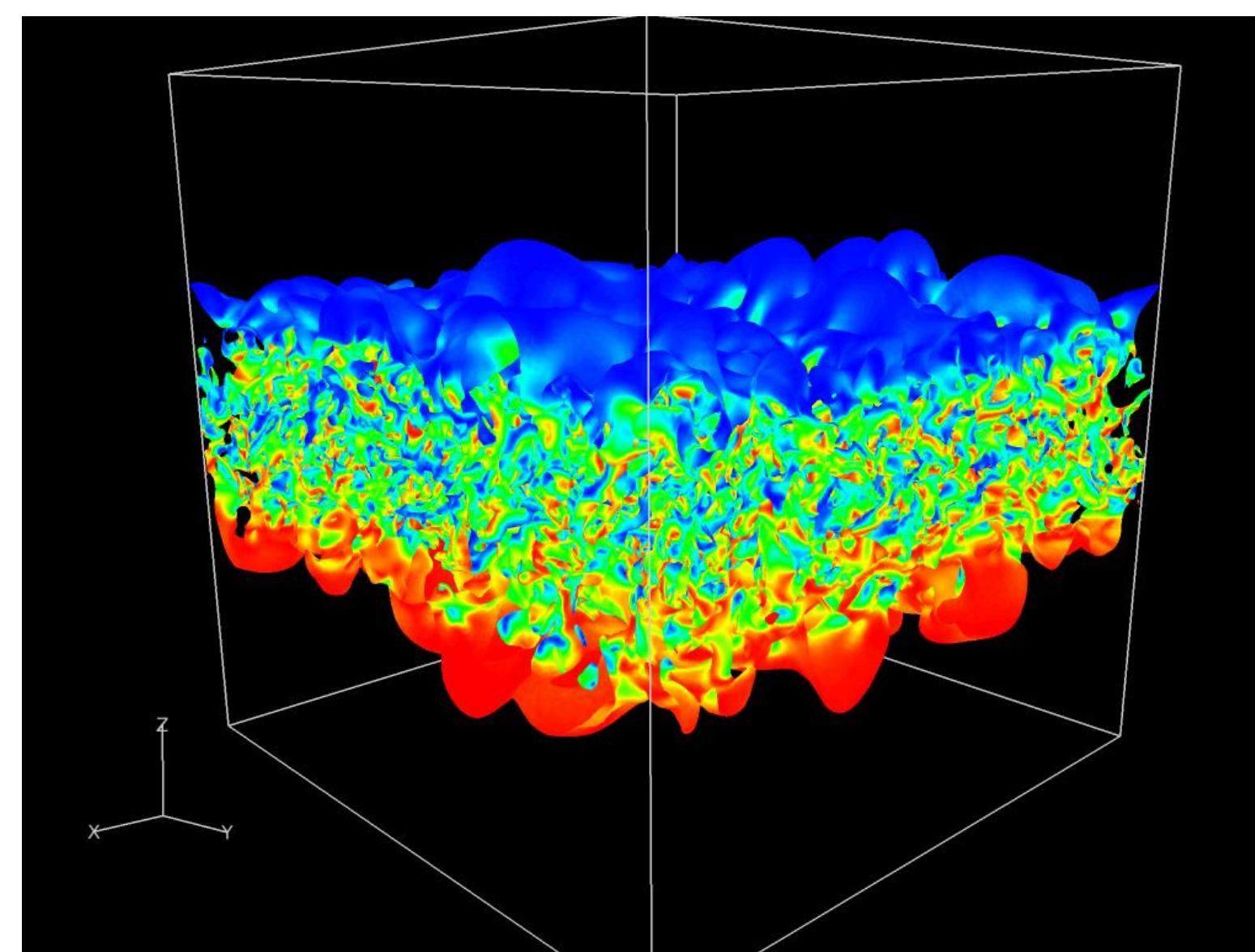
回転系の乱流拡散の運動エネルギー
