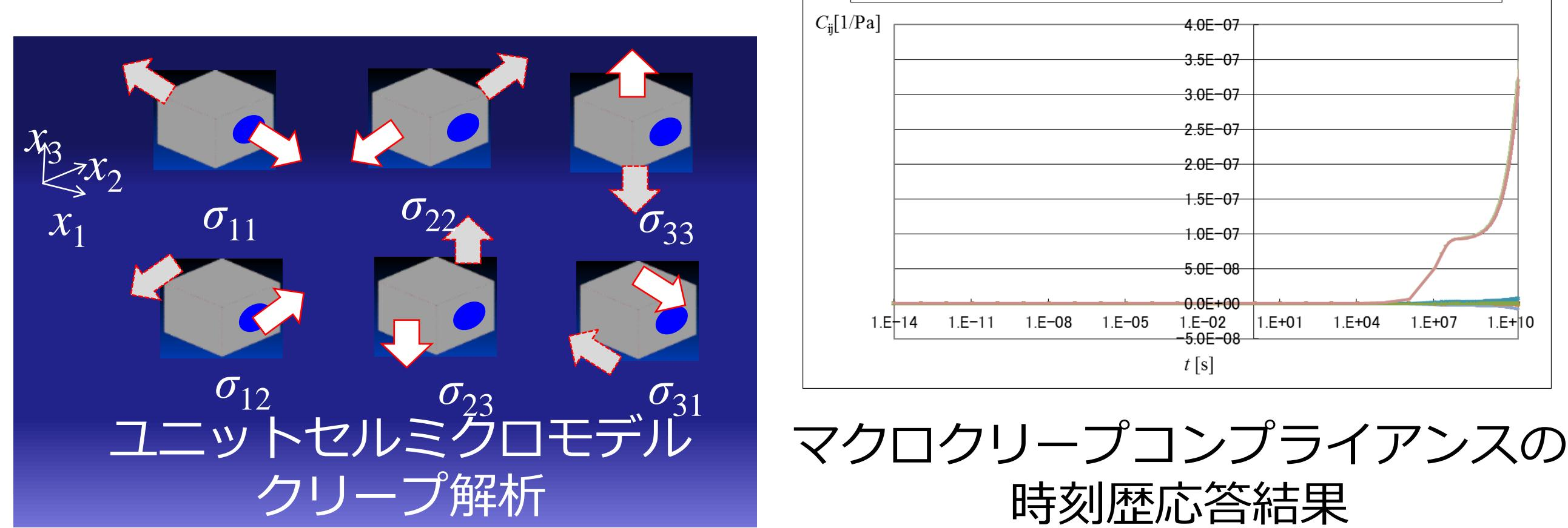
ミクロモデルクリープ解析結果を用いたマクロモデル異方性粘弾性パラメータの同定
