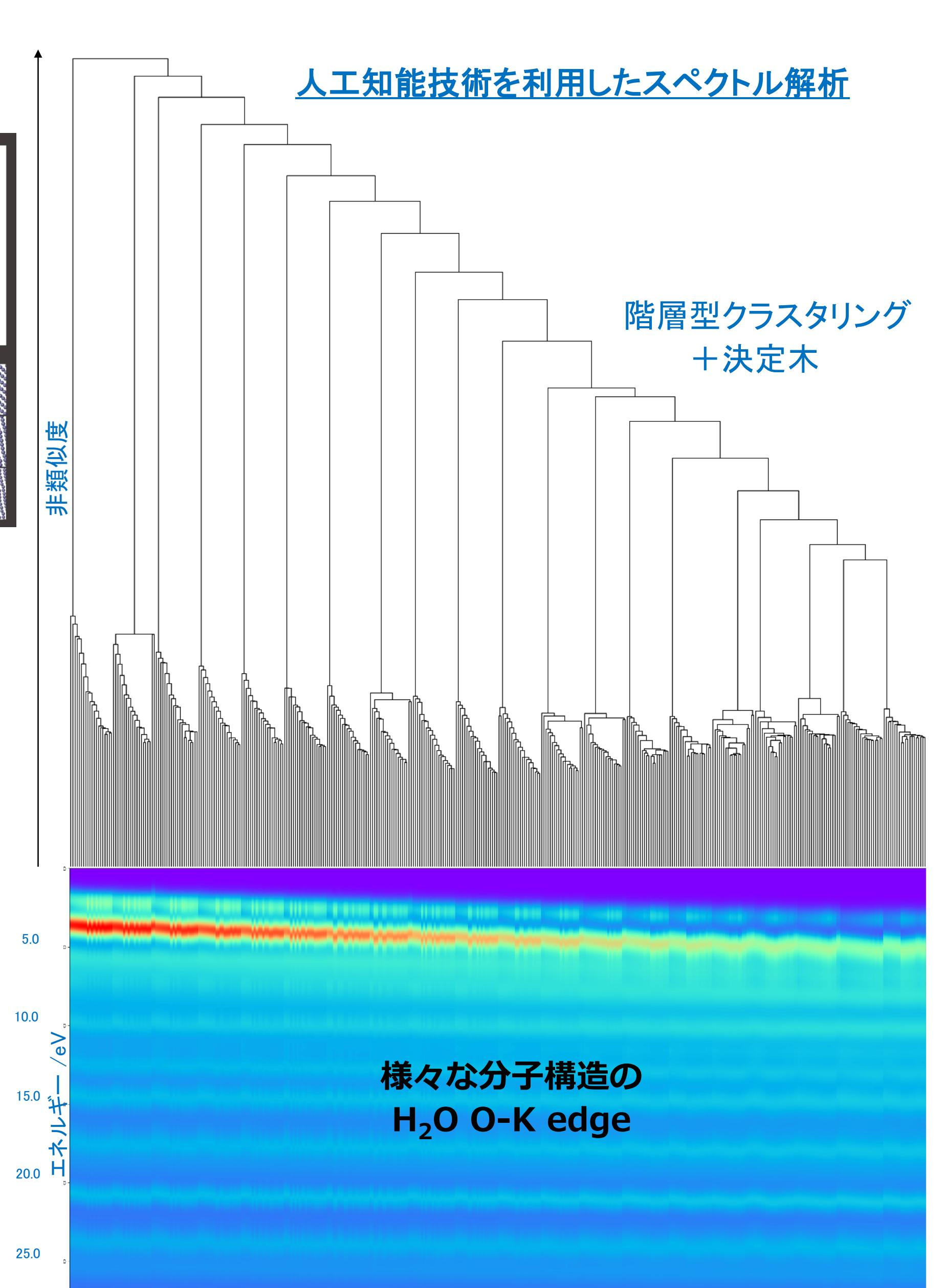
第一原理計算により空孔、界面、転位などの格子欠陥の形成挙動とダイナミクスを調べ、網羅的計算により得られた結果を情報科学手法(インフォマティクス)により処理することでHigh through-put screeningと物質設計を実現することができます。さらに、人工知能技術とスペクトル計測との融合研究も実施しています。人工知能技術を利用することで専門的な知識を必要とすることなくスペクトルを解釈することが可能になります。
