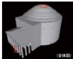
Fig.1 NEXST_FMM で生成したバンテオン寺院の大規模メッシュ(約1800万節点、約1.2億要素)
