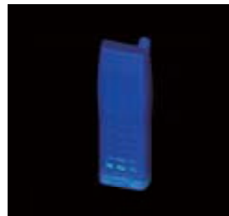
Fig.2 NEXST_Impact による携帯電話の落下衝撃解析
