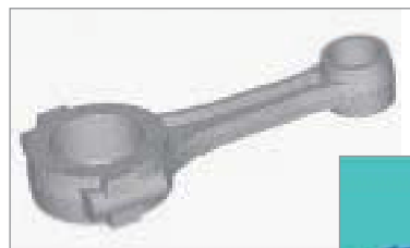
⑤ コンロッドの変形・応力解析 (計算時間 38sec, 8PE 使用時 (R12000, 400MHz)) 上) 4 面体 2 次要素、96,328 節点、 56,115 要素、288,984 自由度 下) ミーゼス応力
